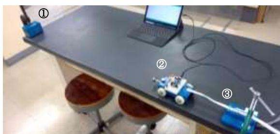
(写真1 ①定力装置 ②力学台車 ③記録タイマー&テープ)
